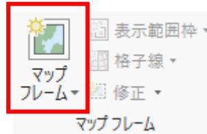
レイアウトに自動的にマップ フレームが追加されました。マップ フレームは、対応するマップを表示するための要素で、シンボルなどマップで調整したものが即座に反映されるようになっています。
