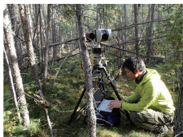
園芸学研究科 助教 加藤 顕 氏 森林内で地上レーザーを用いて3次元データを 取得している様子
