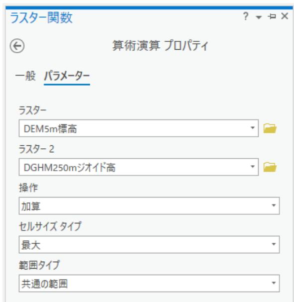
(工)[算術演算 プロパティ] で [操作] が「加算」になっていることを確認し、[新しいレイヤーの作成] をクリックします。
