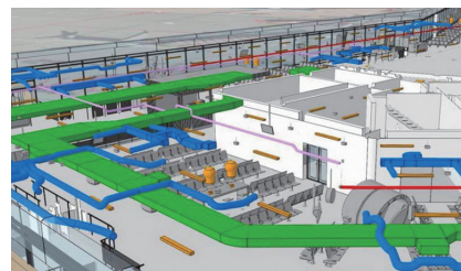
ArcGISのWebシーンに描かれた切斷BIMモデルは、暖房、換気、および空調システムを示している
