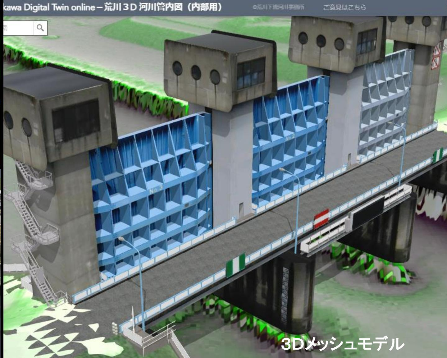
※点群データを3DCADでトレースし表面に写真を貼り付けて作成
